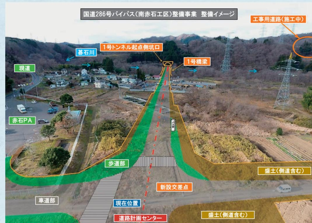
左は赤石パーキングとトイレ、その奥に現在の286号。手前の中央(現在位置)で説明を受ける。ここに交差点が新設され、川崎方面に向かって道路が延長。碓石川を渡る1号橋梁が架けられ1号トンネルへと進む。右上奥に施工中の工事用道路。
