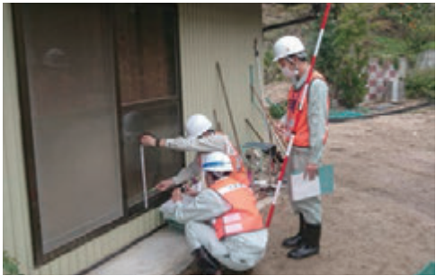
▲床上の浸水高を計測する長谷川係長
