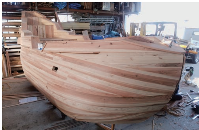
▲外板貼りがほぼ完成した状態
